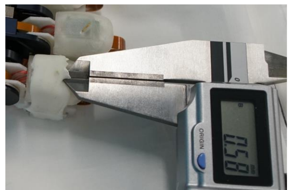
図 3 高伸縮フィルムで覆った指（上側）と調製した酸化アルミ-シリコン樹脂カバーで覆った指（下側、ちぎれない程度に強めにつまんで厚みを計測）
