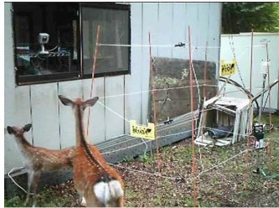
図 3 静電容量センサによって存在情報が検知された有害鳥獣（シカ）
